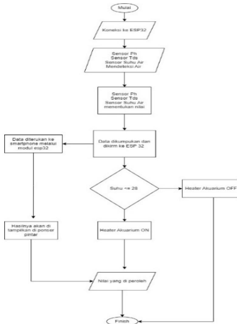
Gambar 3. Flowchart Proses Menampilkan Data Ke Smartphone
